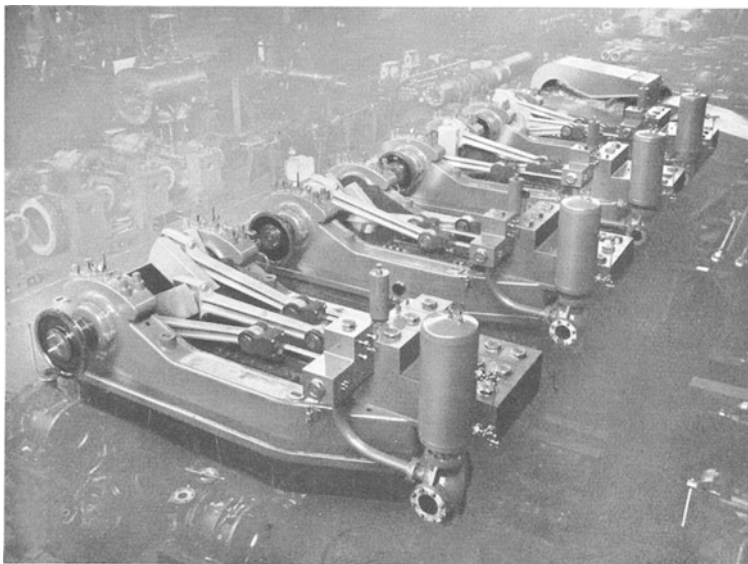
Abb. 59. Einfach wirkende liegende Dreiplungerpumpen mit zweifacher Lagerung der Kurbelwelle, getrennten Pumpenkörpern, hintereinander liegenden Ventilen, Saugwindkessel und angebauter Umlaufvorrichtung. Leistung etwa 300 PS. (Hydraulik G. m. b. H., Duisburg.)
