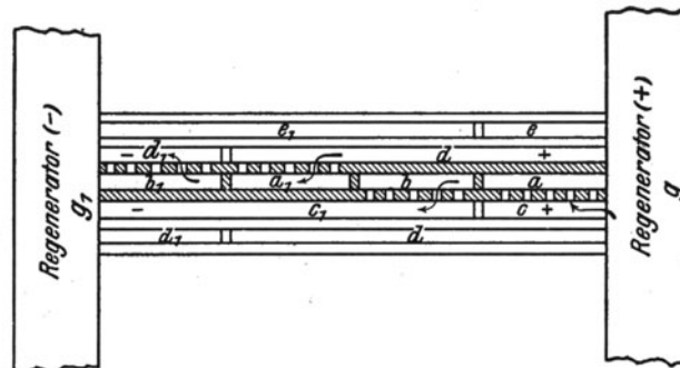
Fig. 10. Schematische Darstellung der Ofenheizung bei der Ottoschen Unterbrenner-Regenerativ-Bauart.
