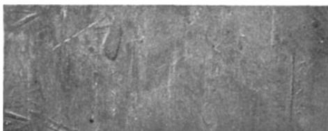
Abb. 264. Das Messingblech nach 800 Stunden ohne Schutz  $v = 2$
