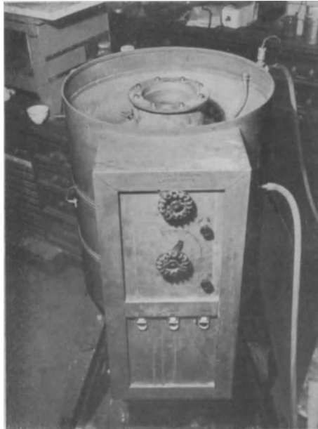
Abb. 111. Druck-Temperatur-Eichgerät der U. S. Marine.
