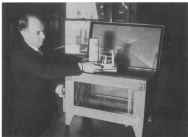
Abb. 114. Feuchtigkeitseichgerät des U. S. Weather Bureau.
