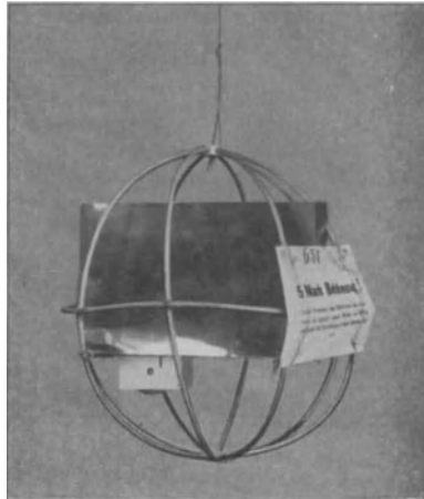
Abb. 12. Kleinmeteorograph nach Aßmann fertig zum Aufstieg.
