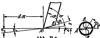
Abb. B 7. Hinterschleifwinkel und Querschnitte.
