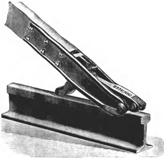
a. Wagenschieber beim Ansetzen an den Wagen.
