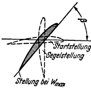
Fig. 94. Blattstellungen für 0,7r eines Verstellpropellers.
