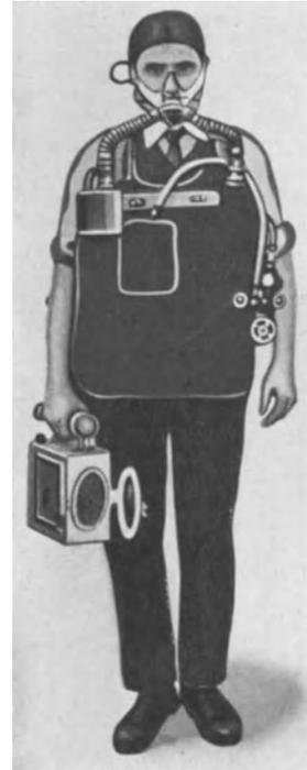
Abb. 65. Rettungsausrüstung für den isolierten Apparat mit dem Käfig mit Testvogel.
