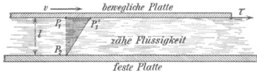
Abb. 442. Der Verschiebungswiderstand einer Platte.
