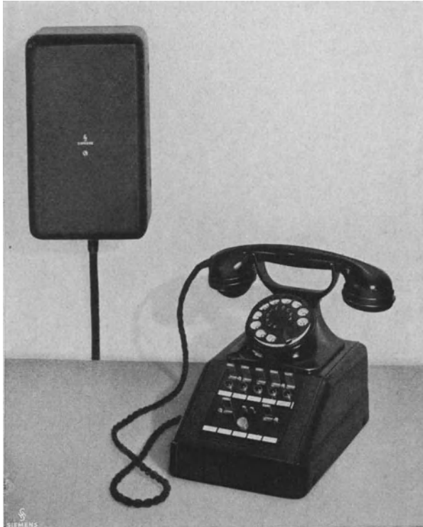
Abb. 40. Hilfsstelle für die Überwachung von fünf Verbindungsleitungen.
