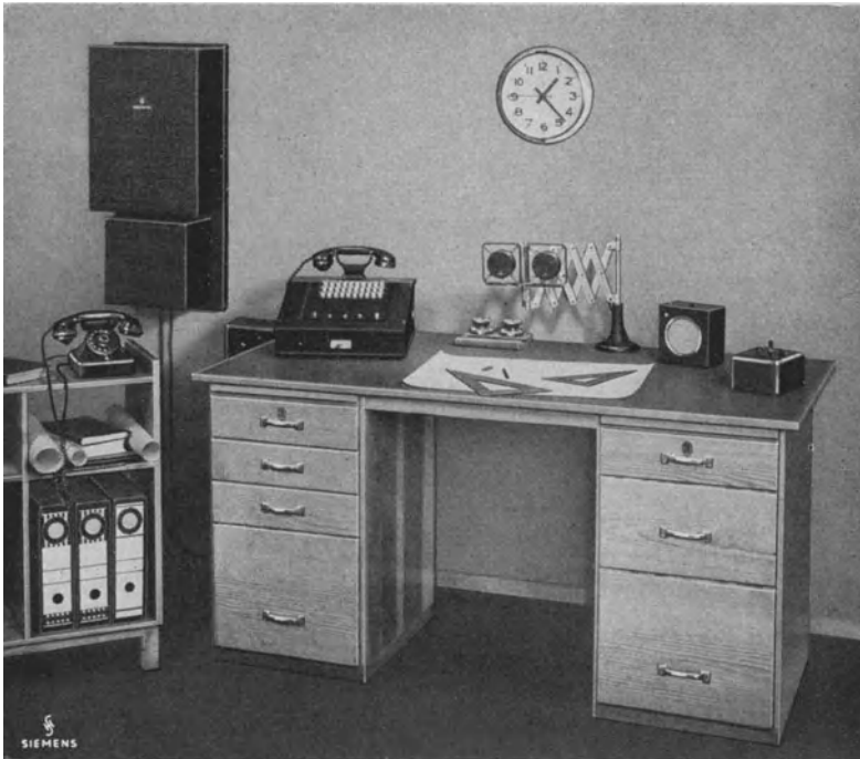
Abb. 129. Befehlstelle einer Befehlsanlage mit Wechselstromwahl.
