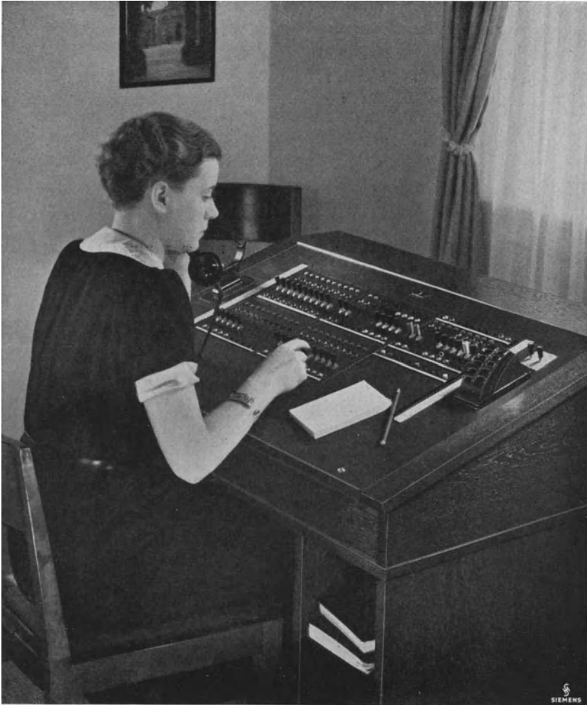
Abb. 89. Halbselbsttätiger Vermittlungsplatz für 50 Anschlußeinheiten.
