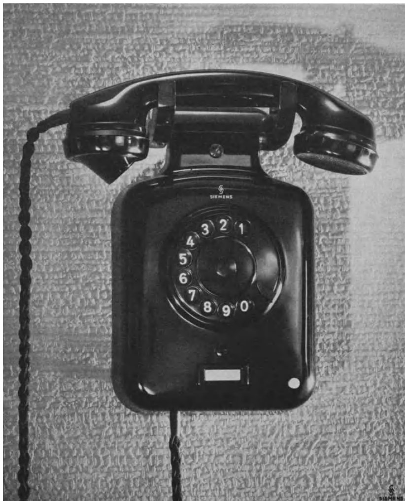
Abb. 98. Wandfernsprecher aus Preßstoff mit Leerlauf-Nummernschalter und Erdungstaste.
