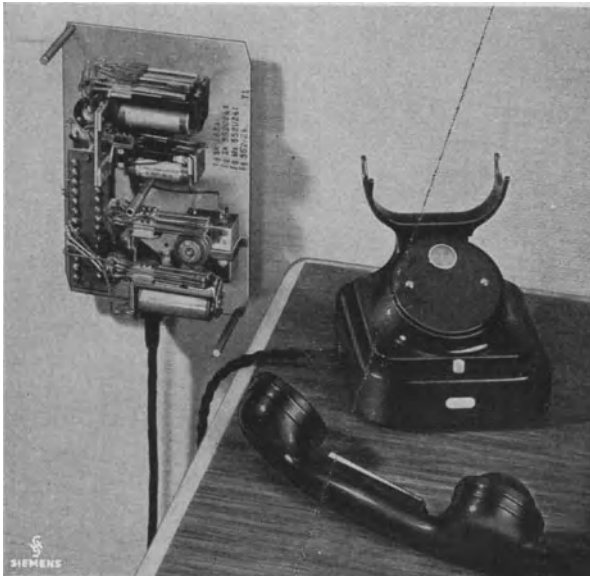
Abb. 133. Außensprechstelle einer Befehlsanlage mit Wechselstromwahl. Der Beikasten (Kappe abgenommen) enthält u. a. ein Wechselstromrelais, zwei Gleichstromrelais und ein Wählerrelais. Der Fernsprecher hat Ruftaste und Schauzeichen.
