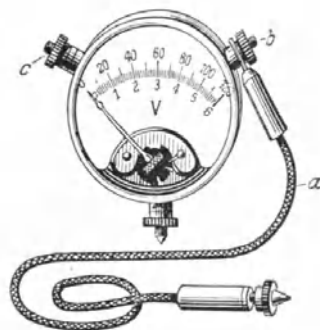
Abb. 60. Voltmeter von Eltax mit durch Kontaktanschluß umschaltbarer Skala.
