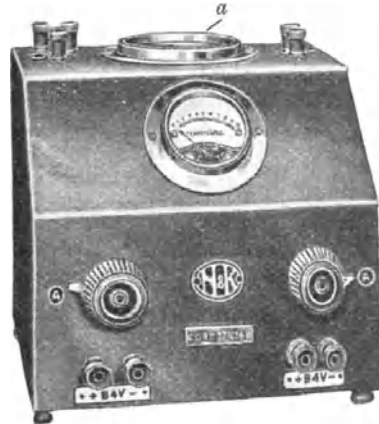
Abb. 27. Lautstärkemesser insbesondere für Kopfhörer.
