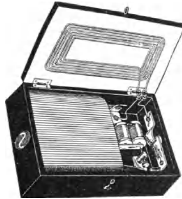
Abb. 22. Prüfsummeranordnung nach E. Nesper, geöffnet.
