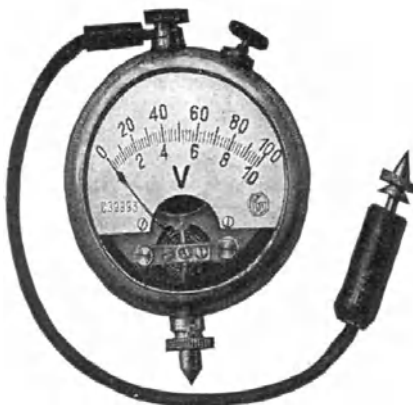
Abb. 59. Kombiniertes Taschenvolt- und Milliamperemeter von Dr. S. Guggenheimer. Type Tp mav.
