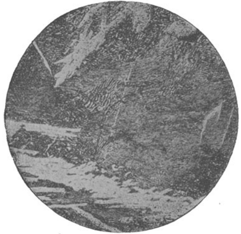
Zementit (hell) + Perlit (lamellar). \times 400
