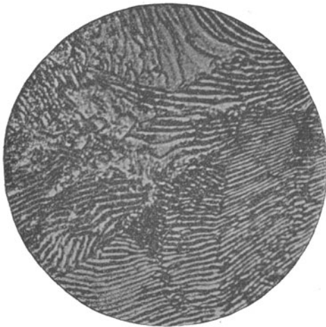
Perlit: Eutektoid mit 0,9 Proz. C. \times 750
