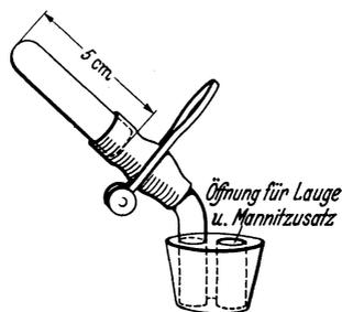
Abb. 16. Gummistopfen mit Prüfröhrchen zum Farbvergleich zwecks  $p_H$ -Einstellung bei der Titration nach FOOTE.
