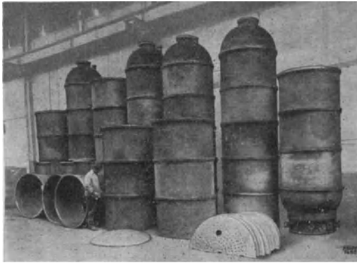
Kolonnenteile aus „Thermisilid“
