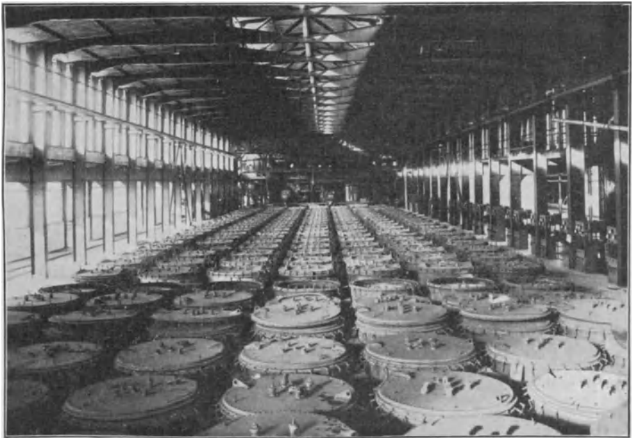
Fig. 91. Kalkstickstoff-Ofenhaus ( Bayer. Stickstoff-Werke ), neuer Typ.
