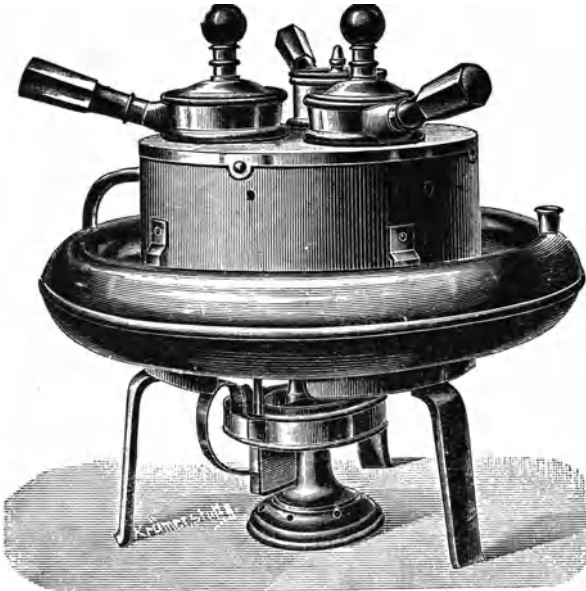
Abb. 51. Infundier-Apparat für 3 Büchsen und auswechselbarer Lochplatte.
