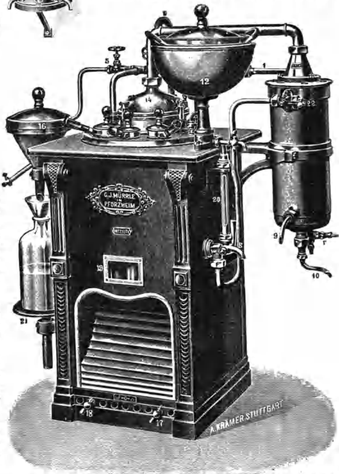
Abb. 26. Moderner Destillierapparat für gespannten Dampf mit Gasheizung.
