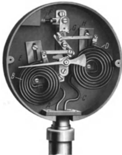
Abb. 162. Quecksilberfederthermometer mit Temperaturkompensation (Schäfer & Budenberg, Magdeburg).
