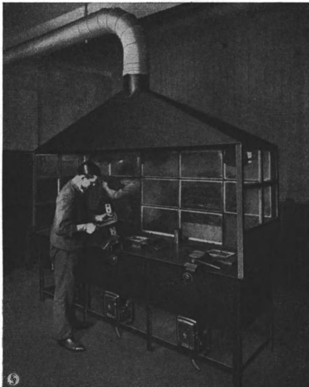
Abb. 194. Zinnschmelzkessel, in den Arbeitstisch eingebaut (SSW, Berlin).
