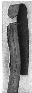
Abb. 108. Zerstörter Bandheizkörper (Paschkis ZV 13).
