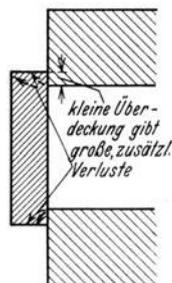
Abb. 139. Die Bedeutung der Türüberdeckung.
