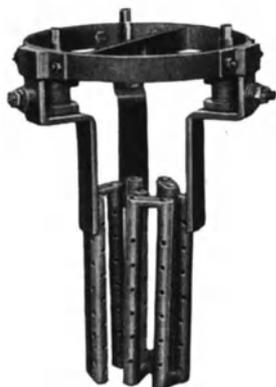
Abb. 247. Zündkäfig (AEG, Berlin). Die in der Abbildung sichtbaren Rohre dienen erstens zur unmittelbaren Umsetzung elektrischer Energie in Wärme und zweitens bei gleichzeitiger Verwendung einer klappbaren Zündelektrode zum Ableiten der Wärme aus dem geschmolzenen Teil in den noch ungeschmolzenen Teil des Salzes.
