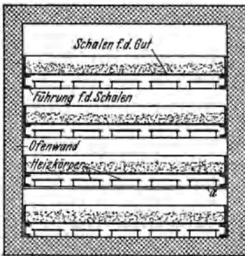
Abb. 174. Anwärmofen mit Wärmeübertragung durch Leitung.
