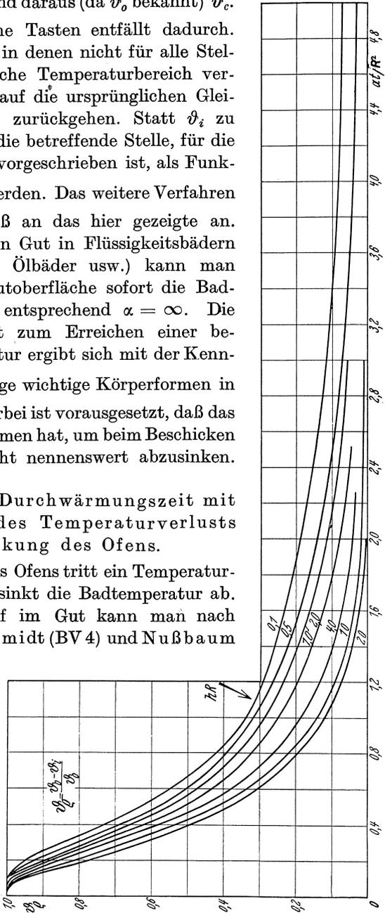
Abb. 7. Relative Mindertemperatur  $\vartheta_o = f\left(\frac{at}{hR}, \frac{at}{R^2}\right)$ . Unendlich ausgedehnte Platte.
