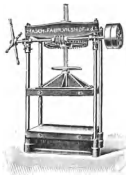
Abb. 147. Lederabwelkpresse für Handbetrieb oder mechanischem Antrieb (Bayerische Maschinenfabrik F. J. Schlageter, Regensburg).
