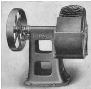
Abb. 281. Kantenausbrechmaschine (Turner A. G., Frankfurt a. M.).
