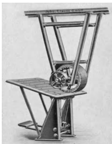
Abb. 210. Bürstmaschine, Deckenanordnung für großflächige Leder (J. Krause G. m. b. H., Altona-Ottensen).
