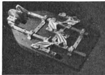
Abb. 349. Apparat zur Prüfung der Biege- und Knitterfestigkeit.
