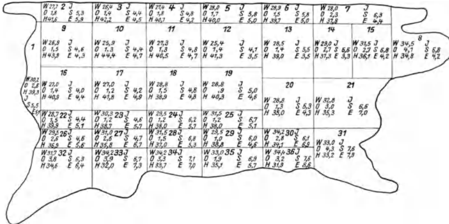
Abb. 323. Unterschiede in der Zusammensetzung des Sohlleders innerhalb einer halben Haut (aus F. H. Small). W Wasser, O Fett, H Hautsubstanz, J unlosliche Asche (nicht bestimmt), S Zucker, E Bittersalz.
