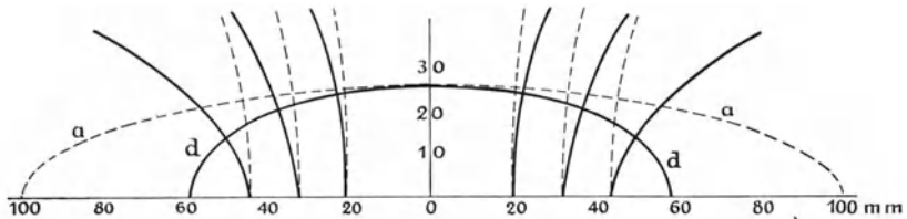
Abb. 1. Verdunstung aus einem kreisförmigen System. Mit den ausgezogenen Linien ist der theoretische Verlauf der Strömungslinien gleichen Dampfdruckgefälles (konfokale Hyperbelbögen) und eine Fläche gleichen Dampfdruckes über dem System (Ellipsenbogen) wiedergegeben. Die gestrichelten Linien entsprechen empirischen Befunden. S. Text. Nach v. PALLICH 1897.
