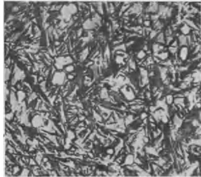
Abb. 33. Gefüge eines richtig gehärteten und auf etwa 600° angelassenen Schnellarbeitsstahles.
