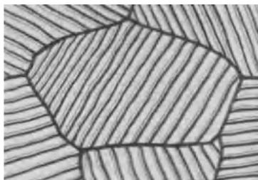
Abb. 5. Einzelner Perlitkristall, schematisch. Kohlenstoffgehalt etwa 0,9%.
