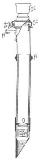
Abb. 16. Eintauchrefraktometer nach Pulfrich.
