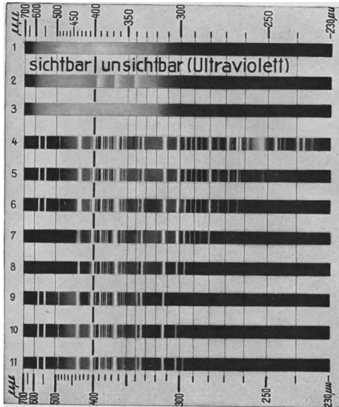
Abb. 190. Spektrum verschiedener Lichtquellen. Wellenlängen in Millionstel mm ( \mu\mu ). Nr. 1. Sonne in der Ebene; Nr. 2. Kohlenbogenlampe; Nr. 3. Solluxlampe (weißglühende Wolframspirale); Nr. 4. Quarzlampe „künstliche Höhensonne“, ohne Filter; Nr. 5. Quarzlampe durch 1,3 mm Klar-Uviolglas; Nr. 6. Quarzlampe durch 2,6 mm (doppelt) Klar-Uviolglas; Nr. 7. Hanauer Quarzlampe durch 1,3 mm Uviolglas-Blaufilter Normal; Nr. 8. Hanauer Quarzlampe durch 2,6 mm (doppelt) Uviolglas-Blaufilter; Nr. 9. Hanauer Quarzlampe durch sehr dünnes Fensterglas (1 mm); Nr. 10. Hanauer Quarzlampe durch Zelluloidschirm 0,25 mm; Nr. 11. Hanauer Quarzlampe durch Glimmerschirm 0,05 mm. (Nach BACH 9 ).
