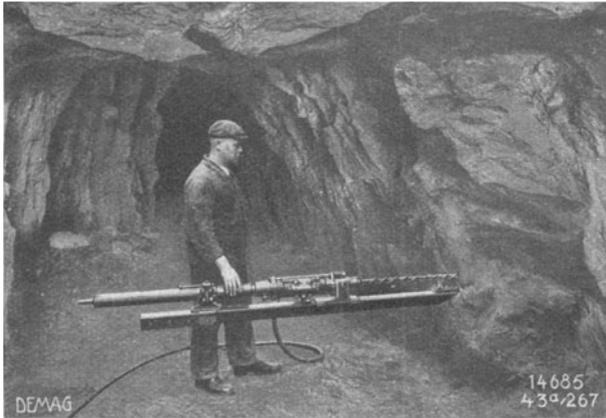
Abb. 16. Demag-Bohrhammer mit Halte- und Preßluft-Vorschubvorrichtung
