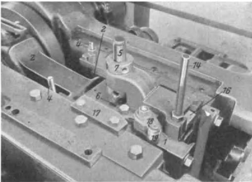
Abb. 45. Doppeldruck-Kaltbolzenpresse: Antrieb des Hauptschlittens.
