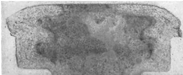
Abb. 50. Gefüge eines kaltgepreßten Bolzenkopfes.
