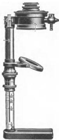
Abb. 2. AITKENScher Kernzähler (nach KLENSCHMIDT, Handbuch der meteor. Instr.).
