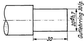
Abb. 171/1. Sondervorschrift für die Prüfung einer Paßfläche.  $20 \varnothing h7 = 20 - 0.21$ .
