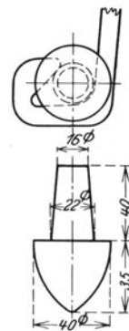
Abb. 167. Unterer Abschluß der Nut der Larsen-Eisen während des Rammens mittels eines kurzen Dornes.
