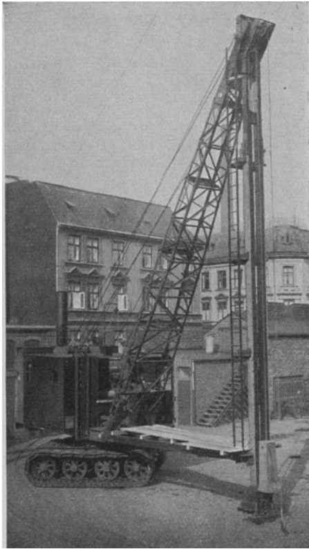
Abb. 474. Auslegerramme mit Freifallbären. (Menck & Hambrock.)
