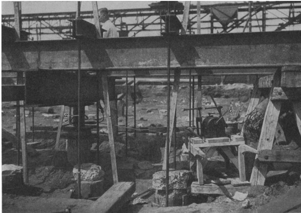
Abb. 73. Belastungsversuch an einem Schleuderbetonpfahl mittels einer hydraulischen Presse a . b Pumpe. (Siemens-Bau-Union.)
