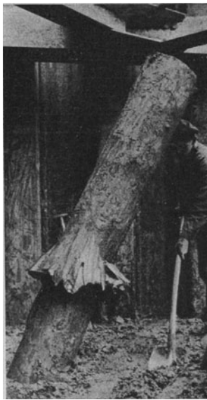
Abb. 449. Durch übermäßiges Rammen gestauchter Holzpfahl. (Vereinigte Stahlwerke A.-G., Dortmunder Union.)
