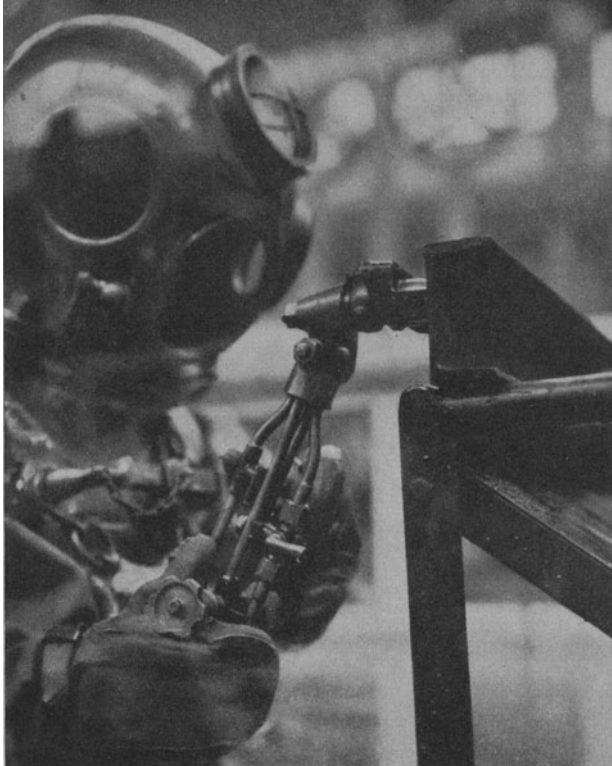
Abb. 177. Taucher mit Unterwasser-Schneidbrenner. (Vereinigte Stahlwerke A.-G., Dortmunder Union.)
