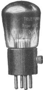
Abb. 24. Normale Raumladungsgitterröhre für den Rundfunkempfang (ca. \frac{2}{3} nat. Größe).
