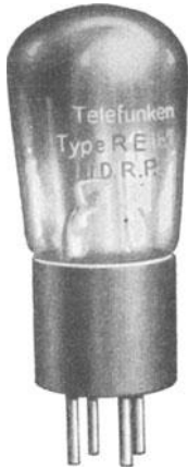
Abb. 15. Normale Rundfunkempfangsröhre. (ca. \frac{2}{3} natürl. Größe.)
