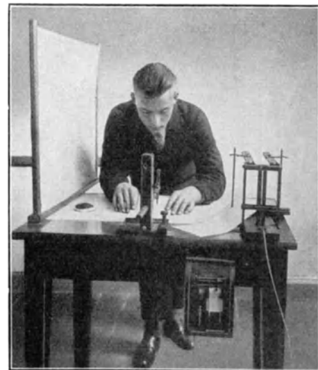
Abb. 497. Beidhändige Genauigkeitsarbeit als Dauerprüfung an der Arbeitsschauuhr.
