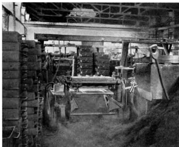
Abb. 55. Rationalisierter Arbeitsplatz an einer Wendepplattenformmaschine.
