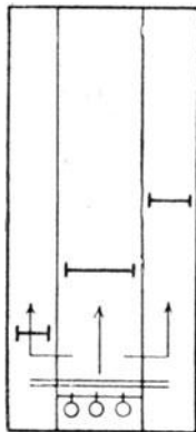
Abb. 168. Dreihallenbau. Öfen vor Kopf.
