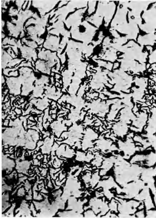
Abb. 433. 2 Stunden bei 900° gegläht, im Ofen ganz langsam abgekühlt. Härte: 130. Gefüge rein Ferrit. Vergr. 200.
