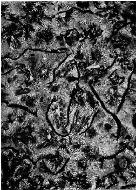
Abb. 432. Gefüge vor dem Glühen. Härte 215. Rein Perlit. Vergr. 200.
