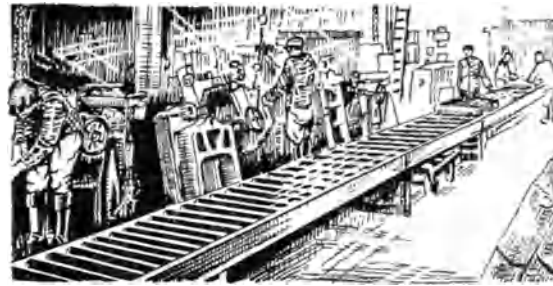
Abb. 300. Bondwerk der American Radiator Co., Rollenförderer für Gliederkessel und Prüfeinwirkung.
