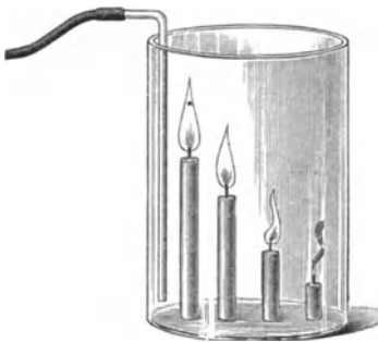
Fig. 169. Kerzenflammen ersticken in aufsteigendem Kohlensäuregas.
