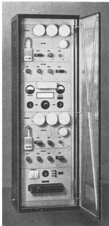
Bild 110b. HF-Gerät nach dem Interferenzverfahren zum Schutz von zwei Drehstromleitungen, Rückansicht.
