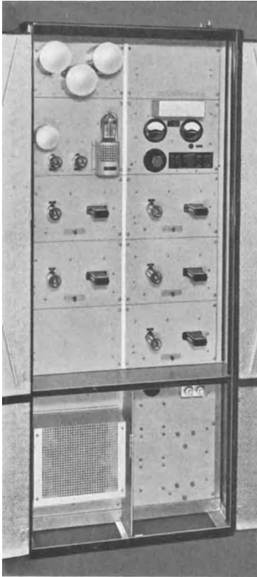
Bild 108a. Sender des mit 6 Tönen modulierbaren Gerätes (Type Siemens & Halske).
