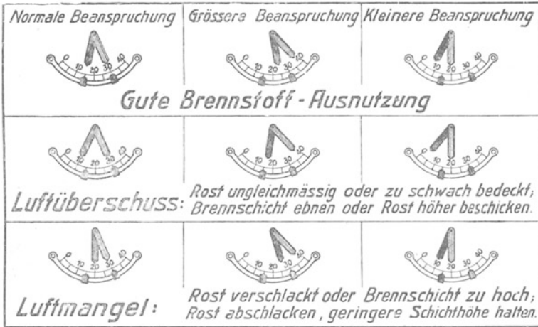
Abb. 30. Verbundzugmesser „Metrum“. Skalenbildtafel für einen Luftüberschuß- und Leistungsmesser mit Zeigerangabe.
