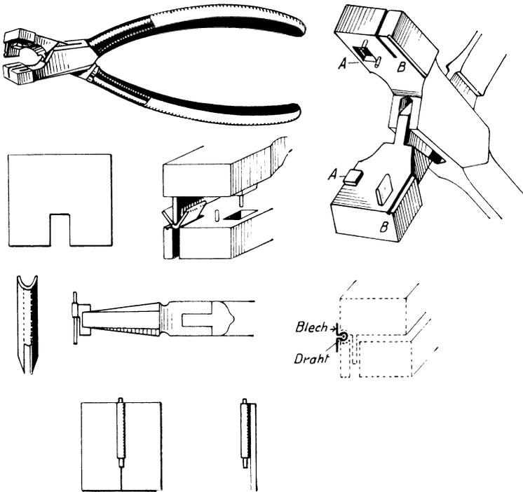
Abb. 129. Rückenplattenzange für Schiebebezüge und Herstellungsgang bei Anfertigung einer Rückenplatte.
