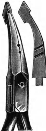
Abb. 164. Bandformzange nach Angle.
