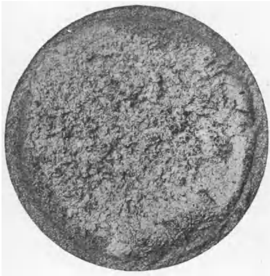
Gebrauchsfertiger Baggerbolzen. v = 3/4 (durchgebrochen) (Bruchfläche geschliffen und geätzt)
