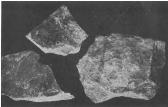
Abb. 10. Kalkstein mit hohem Kalkgehalt, wie er zur Portland- und Hüttenzementfabrikation verwendet wird (1/2 der nat. Größe).
