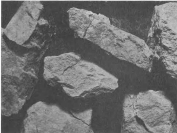
Abb. 1. Ungesintertes Bindemittel: Hydraulischer Kalk nach dem Austritt aus dem Ofen vor der Vermahlung ( $\frac{1}{2}$  der nat. Größe).
