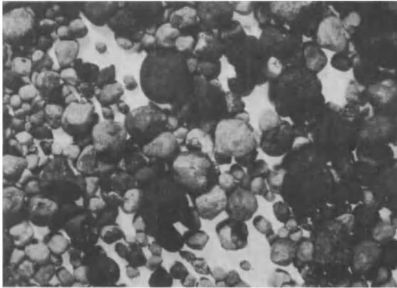
Abb. 2. Gesintertes Bindemittel: Drehofenklinker ungemahlen ( $\frac{1}{2}$  der nat. Größe).
