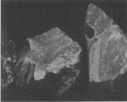
Abb. 18. Durch langsame Abkühlung aus der glühendflüssigen Schlacke erhaltene „Stück“-Schlacke, geeignet als Gleisschotter usw., nicht geeignet als Zumahlschlacke bei der Hüttenzementherstellung ( $\frac{1}{2}$  der nat. Größe).
