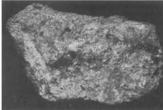
Abb. 5. Tuffstein, aus welchem durch Vermahlung Traß hergestellt wird
