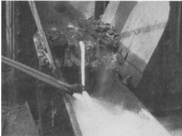
Abb. 33. Wassergranulation von Schlacke.
