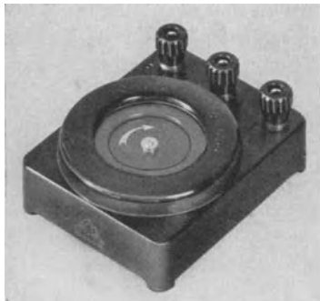
Abb. 44. Drehfeldzeiger nach dem Drehfeldmotorprinzip.
