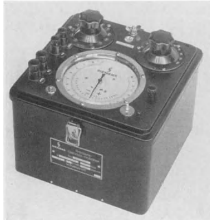
Abb. 57. Gleichlast-Prüfzähler der SSW.
