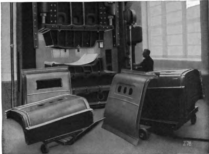
Abb. 344. Tischansicht einer Kniehebel-Breitziehpresse mit Werkzeug zum Ziehen von Karosserie-Rückwänden mittels Preßluft. (Maschinenfabrik Weingarten.)
