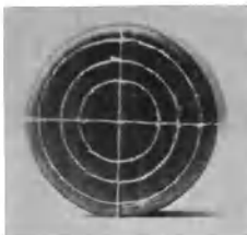
Abb. 16. Lage konzentrischer Kreise der Ziehbleche nach der Umformung auf Boden und Wand eines Hohlgefäßes.
