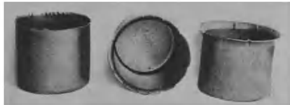
Abb. 167. Ziehfallen. Abb. 168. Falten- und Zipfelbildung bei großer Ziehringrundung.
