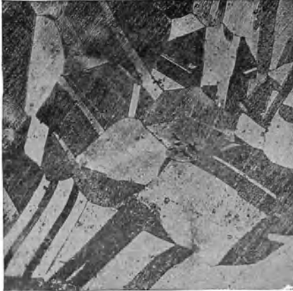
Abb. 39 a. Messing mit 20% Zn (geglüht). \alpha -Polygone. \times 300 . (Aus Goerens: Metallographie.)
