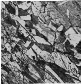
Abb. 47 a. Mikroskopisches Bild (100×) eines durch Tiefzug verformten Blechs. Starke Dehnung — Verzerrung der Kristalle.
