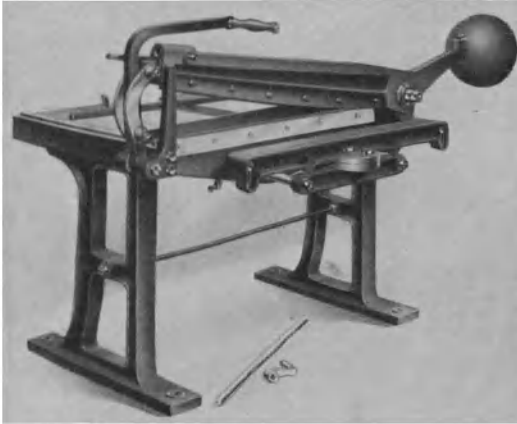
Abb. 102. Tafelschere mit Hebelübersetzung zur Erleichterung des Schneidens. (C. Kneusel.)
