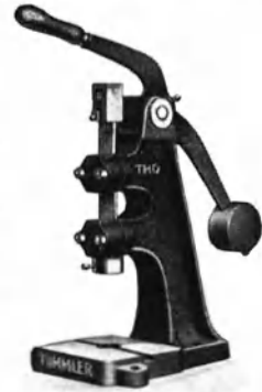
Abb. 113. Handhebelpresse. (Gebr. Tümmeler.)
