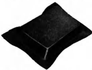
b Das Ziehteil! Ohne Falten und Risse. Abb. 205a und b. Pneumatische Niederhaltung. Praktisch konstanter Niederhalterdruck. (Maschinenfabrik Weingarten.)
