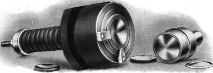
Abb. 198b. Ziehwerkzeug mit Niederhalterfeder im Unterteil (Ansicht). (Maschinenfabrik Weingarten.)
