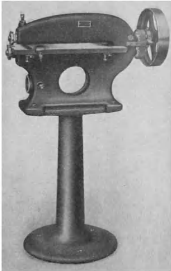
Abb. 106. Kreisschere zum Schneiden langer Bänder. (L. Schuler.)
