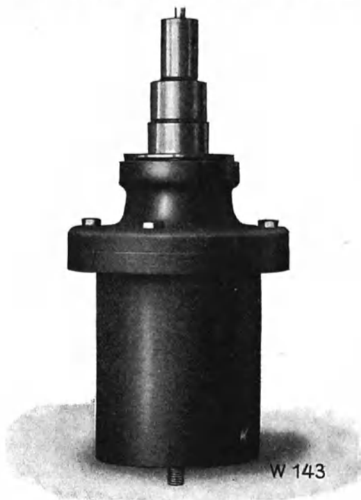
Abb. 280a. Verbundwerkzeug für Anschlag und Weiterschlag, dessen Niederhalter von einem Doppelzugpreßluftzylinder betätigt werden. (Maschinenfabrik Weingarten.)
