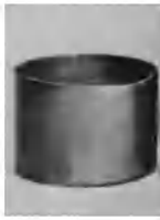
Abb. 350. Der Rand ist wenig gezackt, der Niederhalterdruck also annähernd richtig.
