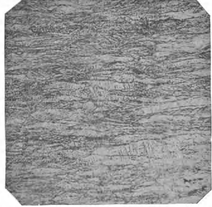
Abb. 39 b. Messing mit 20% Zn (kalt gewalzt). Verzerrte \alpha -Polygone. \times 300 . (Aus Goerens: Metallographie.)
