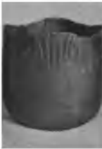
Abb. 167. Ziehfallen. Abb. 168. Falten- und Zipfelbildung bei großer Ziehringrundung.
