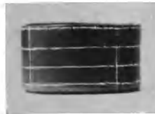
Abb. 16. Lage konzentrischer Kreise der Ziehbleche nach der Umformung auf Boden und Wand eines Hohlgefäßes.
