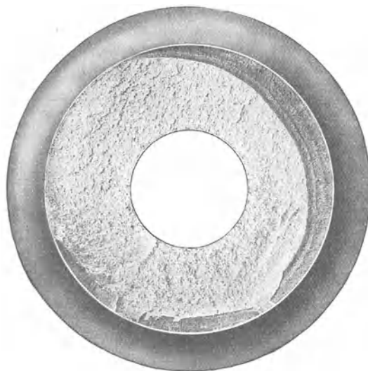
Abb. 41. Anriß einer Welle infolge Schmiedefehlers (nach Lasche-Kieser).
