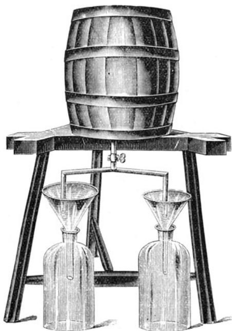
Die nebenstehende Abbildung wird am besten die Bauart des Apparates versinnbildlichen, wobei von vornherein gesagt sein mag, daß die Zahl der Filter, die hier, um die Zeichnung nicht zu verwickelt zu machen, nur zwei beträgt, durch Verlängerung bzw. Verzweigung
