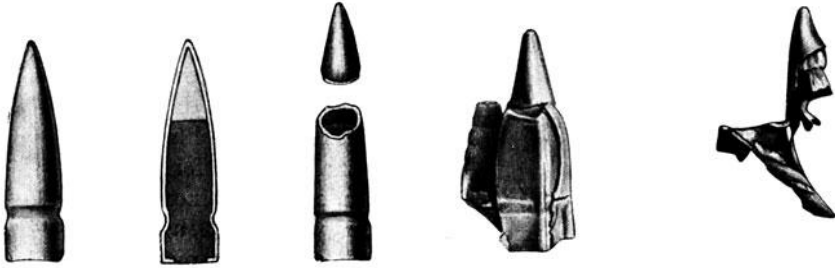
Abb. 8. Aluminiumspitzengeschoss nach v. Bruns.
