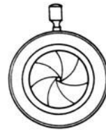
Abb. 77. Eine Iris-(Stell-)Blende stark zusammengezogen.
