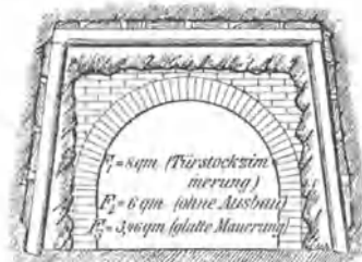
Fig. 435. Streckenquerschnitte mit gleichem Widerstande für den Durchzug der Luft.
