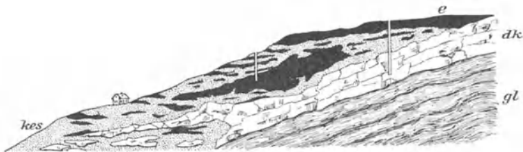
Fig. 46. Eisenerzlager, -Stöcke und -Nester auf Elba. Nach Fabri. e Erz, dk dolomitischer Kalkstein, gl Glimmerschiefer, kes Kalk-Eisen-Silikatgestein.
