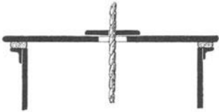
Fig. 475. Schachtdeckel mit kleinerem Deckel für das Seilloch.
