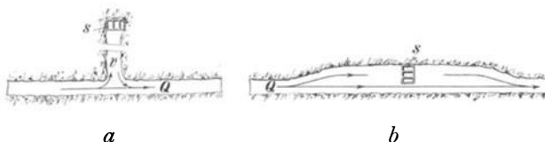
Fig. 287. Verschiedene Lage eines Stapels zum Querschlage.
