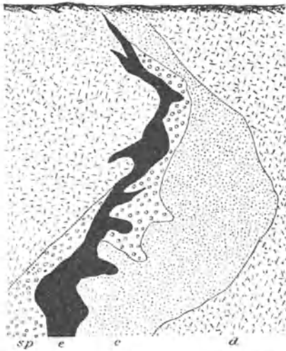
Fig. 44. Kupfererzstock von Monte Catini in Toskana. Nach G. vom Rath. e Erz, sp Serpentin, c Konglomerat, d Diabas.
