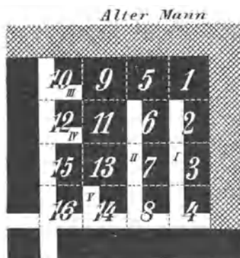
Fig. 324. Fig. 325. Fig. 324 und 325. Deutscher Braunkohlenbruchbau in horizontalen Scheiben.
