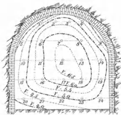
Fig. 429. Kurven gleicher Wettergeschwindigkeit in einem Streckenquerschnitt.
