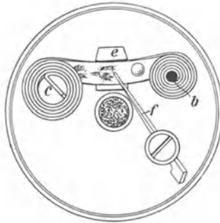
Fig. 540. Seippel'sche Reibzündvorrichtung für Explosionspillenstreifen.
