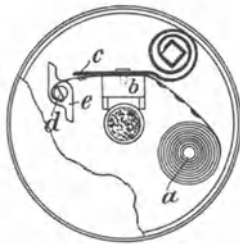
Fig. 542. Wienpahl'sche Schlagzündung für Explosionspillenstreifen.
