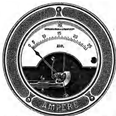
Abb. 21. Hitzdrahtampereometer der Firma Hartmann & Braun, A.-G. Frankfurt a. M. (Der den Hitzdraht spannende Draht und die Feder sind sichtbar.)
