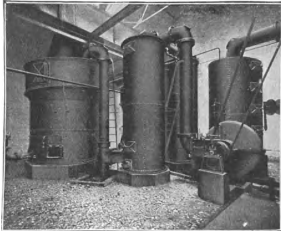
Abb. 105. Crossleys Holzgasgenerator, 350 PS (in der Zündholzfabrik der Firma Bryant & May, Liverpool, in Betrieb).
