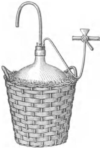
Abb. 21. Heber mit Luftpumpe.
