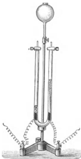
Abb. 524. Sauerstoffgewinnung durch Elektrolyse.
