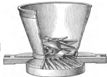
Abb. 632. Farbmühlentrichter mit Schaufelrädern.
