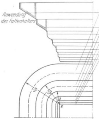
Abb. 93. Ziehstufen für rechteckige Hohlgefäße.
