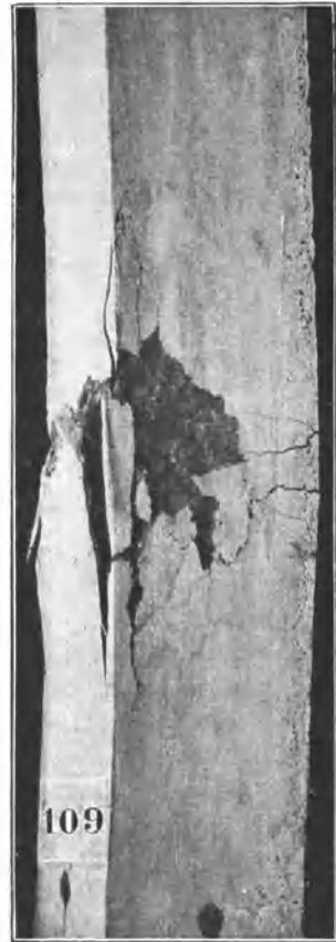
Abb. 112. Bruchbild einer auf Knickung beanspruchten Säule.
