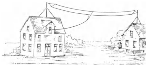
Abb. 71. Doppel-T-Antenne in richtiger Anordnung.
