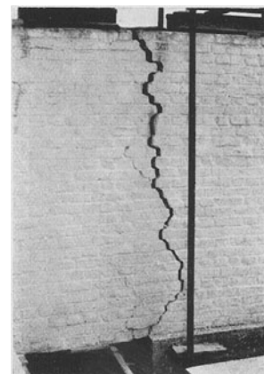
Bild 7. Mauer-Ziegel in Kalkmörtel bei einseitiger Auflagerung bis zum Bruch belastet
