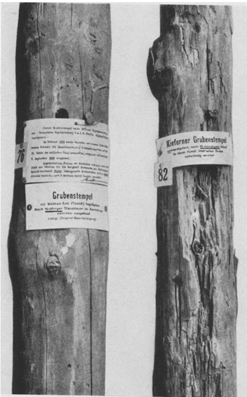
Aufnahme: Allgemeine Holzimprägnierung G. m. b. H. Berlin Bild 4. Wiedergabe eines imprägnierten und nicht-imprägnierten Grubenstempels
