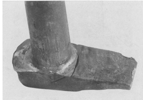
Bild 5. Falsch hergestellte Hammerkopfschraube nach der technologischen Prüfung
