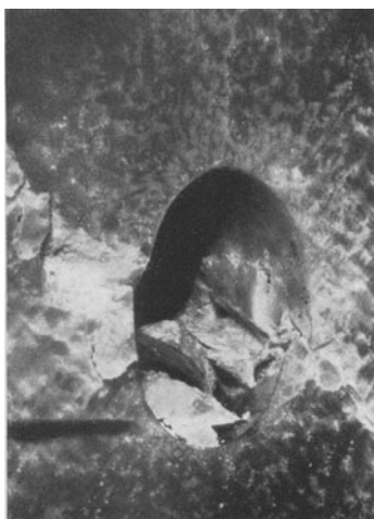
Bild 31. Gleicher Versuchskörper wie Bild 29 im späteren Versuchsstadium. Man erkennt, daß aus den Stößen stets neue „Schalen“ ausgeworfen werden
