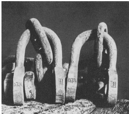
Bild 7. Zwischengeschirr-Schäkel mit unzureichender Kennzeichnung am gefährdeten Querschnitt
