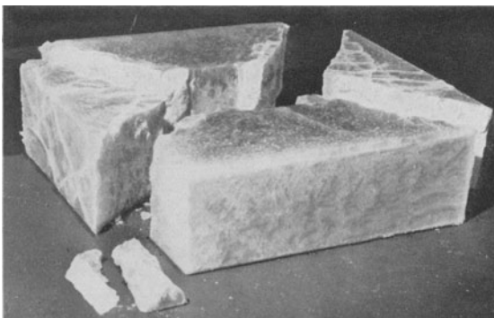
Bild 14. Paraffinkörper mit quadratischer Lücke nach dem Versuch bei Versuchsordnung III
