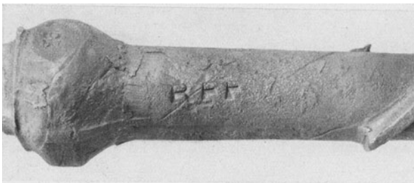
Bild 5. Oberflächenverletzung durch eingeschlagene Buchstaben
