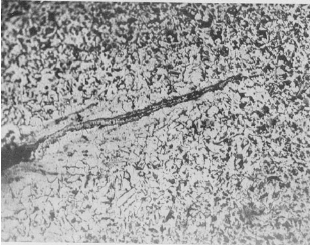
Bild 4. Schliff durch Stichbildung, 150 ×
