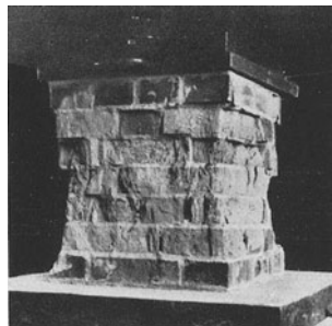
Bild 2. Würfelförmiger Mauerwerkskörper gem. DIN 1056 bis zum Bruch belastet
