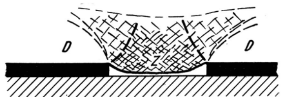
Bild 2. Zweiter Abschnitt der Formänderung: Erweiterung des „Zug-Körpers“; Zerrüttung und Nachbrechen des Nebengesteins bis an die Grenzen des Druck-Körpers
