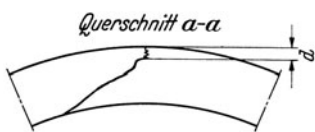
Bild 14. Bruchverlauf in einem geplatztten Hochdruckrohr
