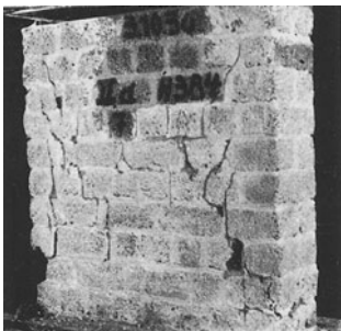
Bild 1. Wandförmiger Mauerwerkskörper gem. DIN 4110 bis zum Bruch belastet
