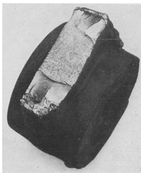
Bild 8. Bruchfläche des gebrochenen Hauptbremshebels
