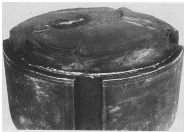
Bild 2. Bruchfläche mit Winkelgrund des Wulstansatzes, Achse Nr. 1
