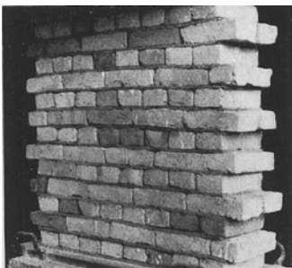
Bild 3. Novadom-Bauweise. Mörtelloses Mauerwerk (Lagerfugen mit Holzwollplatten)
