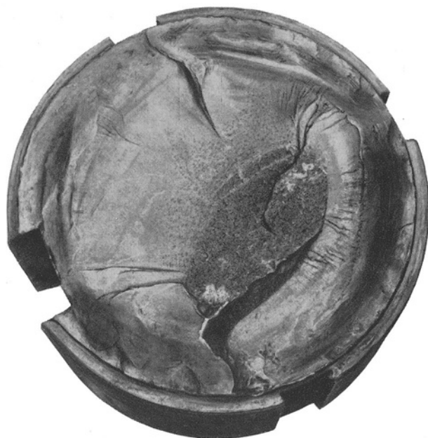
Bild 4. Bruchfläche der Achse Nr. 1
