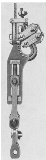
Bild 2. Klemmkause Bauart Demag mit Spindelversteckung (Spindel auf Druck beansprucht) und mit zwei Kreuzgelenken
