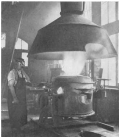
Abb. 65. Die Wärmeschutzbrille im Gebrauch in der Eisengießerei. (Nach C. Zeiß, Jena.)
