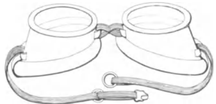
Abb. 74. Sog. Chemiker-Schutzbrille gegen Dämpfe, Rauch und Gase. (Von Heinrich Floth, Fürth i. Bayern.)
