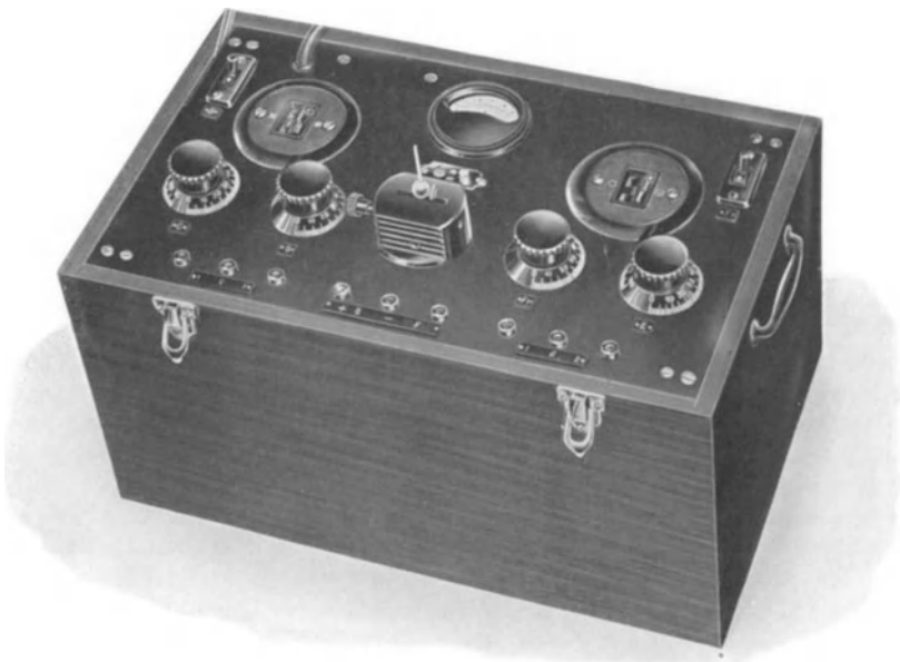
Abb. 25. Netzumformer, für galvanischen und faradischen Strom eingerichtet. Arbeitet mit Glühkathodenröhren (Siemens & Halske).
