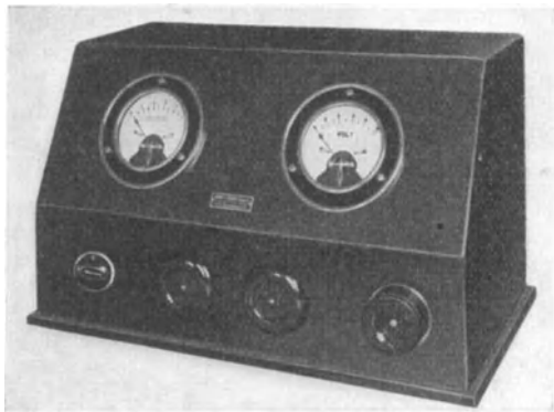
Abb. 3. Elektrolyse-Schaltpult. (Bauart Janke & Kunkel K.G., Köln.)
