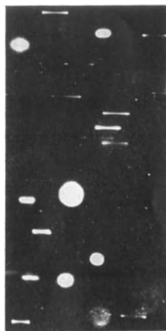
Abb. 12. Schwingende Teilchen eines ungleichteiligen Aerosols im Schallfeld. (Nach Brandt, Freund und Hiedemann.)
