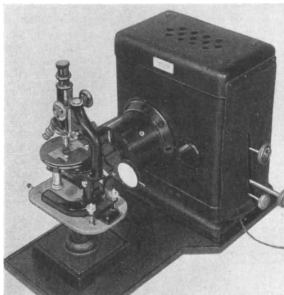
Abb. 1. Gesamtansicht der vollständigen Reichert-Apparatur für Fluoreszenzmikroskopie nach M. Haitinger.
